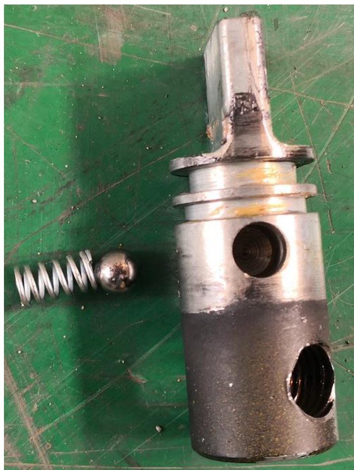
松闸顶杆及定位装置（一个弹簧）
