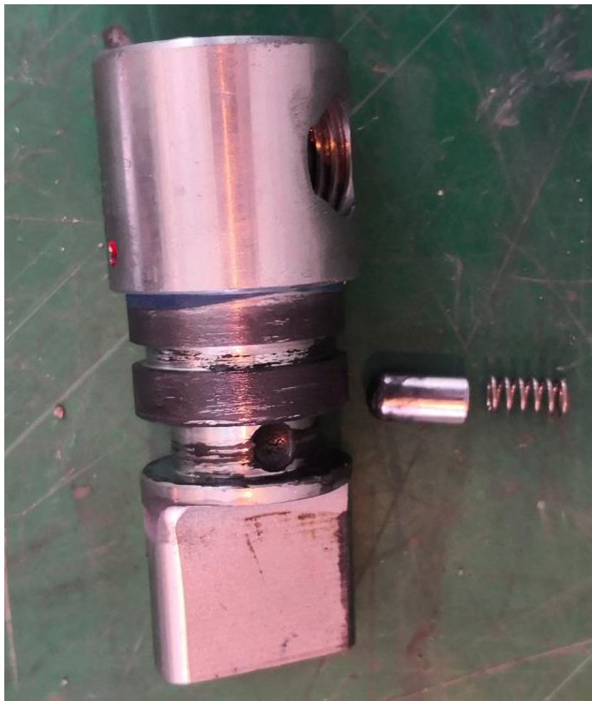
松闸顶杆及定位装置（一个弹簧）
