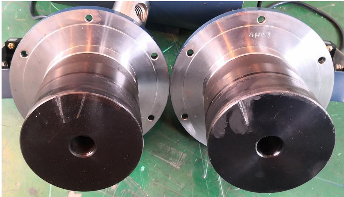
600 次手动松闸试验后的铁芯端面
